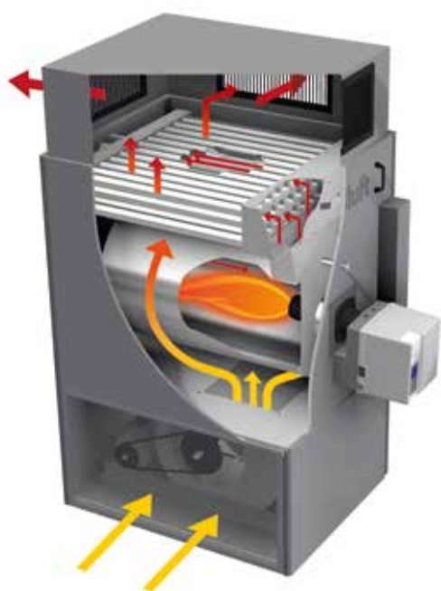
Funktionsschema direktbeheizter Warmluftherzeuger
